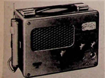
Bild 4. Signalverfolger SV 1 mit angestecktem Tastkopf
