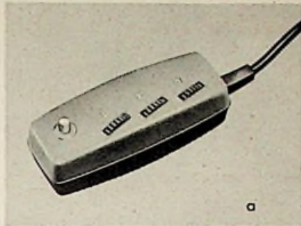
Bild 1. Philips-Fernseh-Fernbedienung Typ 60; a = Bedienungskästchen mit Ton-Abschaltknopf und Einstellern für Lautstärke, Kontrast und Helligkeit; b = Stecker am Gerätechassis
