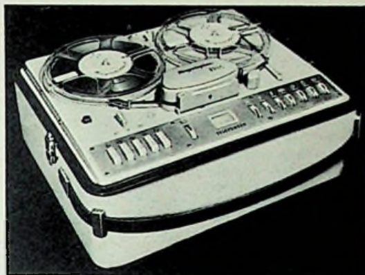
Bild 1. Telefunken-Kleinstudiogerät 24 K, Kleinkoffer mit 6-W-Gegentakt-Endstufe ohne Lautsprecher. Ferner besteht eine Ausführung 24 T ohne Endstufe in einfacher Holzschutulle zum Einbau in Studiostische
