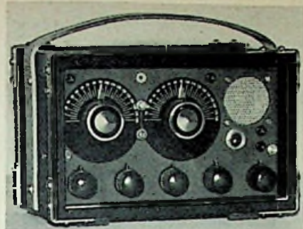
Bild 1. Der Transistor-KW-Empfänger ist in einem stabilen Gehäuse untergebracht, das zum Teil mit Kunststoff überzogen wurde
